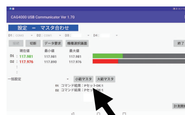
マスタセットはワンタッチ NGの場合は、赤色・ブザーで警告 One-touch master set In case of NG, warning with red color and buzzer
